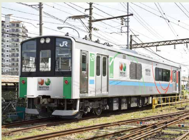
東日本旅客鉄道株式会社様 蓄電池駆動電車(試験車両)
